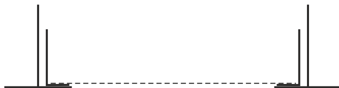
Unsichtbare Montage an der abgehängten Deckenkonstruktion - Frontplatte 595x595
